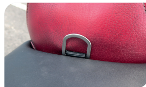
PHOTO N° 6 : EXEMPLE MONTAGE DE SANGLE DE SELLE MOTO SUR MOTO
