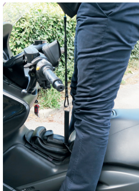
ZDJĘCIE NR 9: DOPASOWANIE DŁUGOŚCI PASKA SIODŁOWEGO NA SKUTERZE
