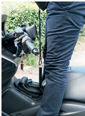
FOTOGRAFIA N.º 9: REGULAÇÃO DO COMPRIMENTO DA CORREIA PARA SELIM DE MOTOCICLO NUMA LAMBRETA
