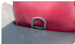
FOTOGRAFIA N.º 6: EXEMPLO DE MONTAGEM DE CORREIA PARA SELIM DE MOTOCICLO NUMA MOTA
