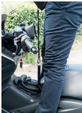
FOTO N° 9: REGOLAZIONE DELLA LUNGHEZZA DELLA CIN- GHIA FISSATA ALLA SELLA DI UNO SCOOTER
