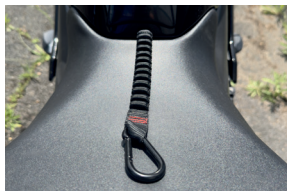
FOTOGRAFIA N.º 12: EXEMPLO DE MONTAGEM DE CORREIA ELÁSTICA PARA SELIM DE NUMA MOTA
